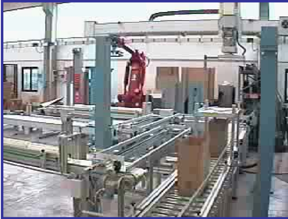
Linea d'inscatolamento e pallettizzazione di bobine di film estensibile (Alfio e RED 5)
