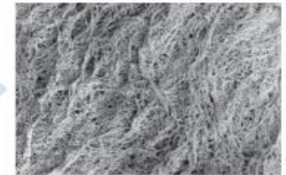
Fig. 2: Superficie compatta, occlusiva a livello cellulare (SEM 1500x)
